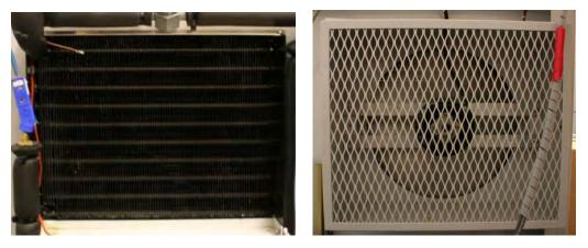
Figure 2.7 The condenser fan unit
